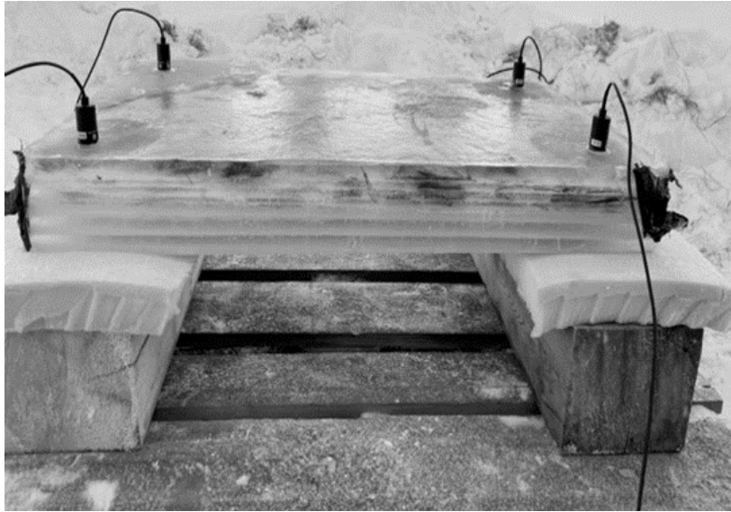
Массивный образец композиционного ледового материала с установленными датчиками акустической эмиссии
