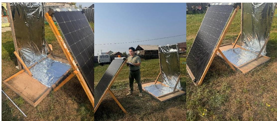
Рис. 3. Натурные исследования с плоским отражателем
