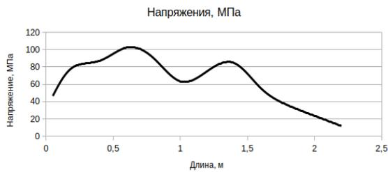
Рис. 6. Вычисленные напряжения после деформации на 8 мм
