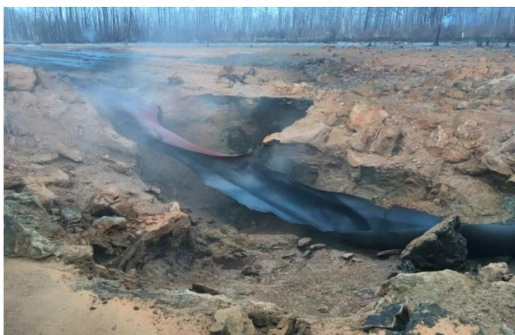
Рис. 2. Разрушенный участок 239 км 1 нитки МГ «Таас-Тумус – Якутск»
