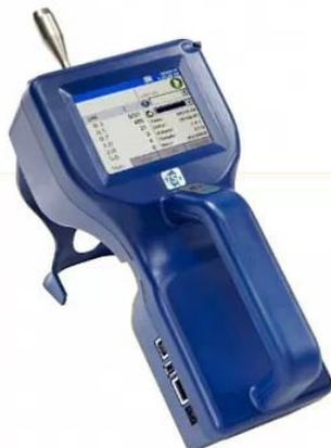
Рис. 1. Переносной счетчик частиц TSI AeroTrak 9306-V2
