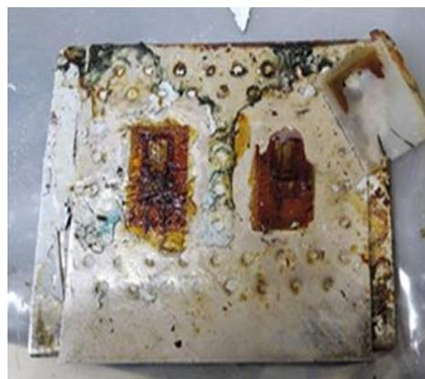
Рис. 6. Уничтоженный солевой коррозией тензометрический датчик деформации
