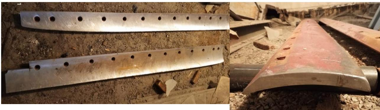
Рис. 1. Общий вид фрагментов ножей среднего отвала автогрейдера Volvo G930
