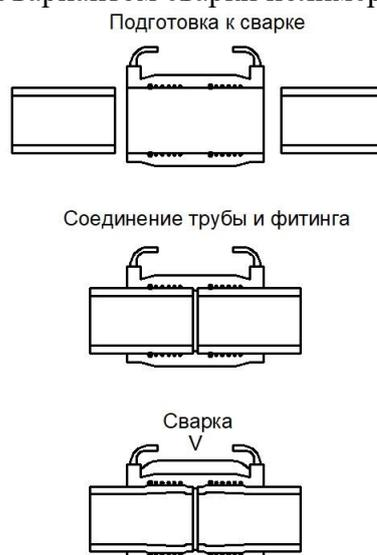
Рис. 1. Этапы процесса электромуфтовой сварки полимерных труб
