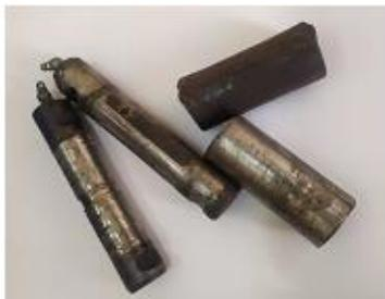
Рис. 1. Общий вид деталей грузового автомобиля: палец и втулка
