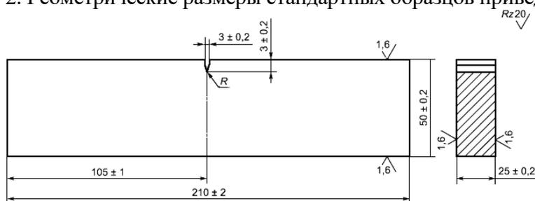
Рис. 1. Образец с краевым концентратором для испытаний на трещиностойкость
