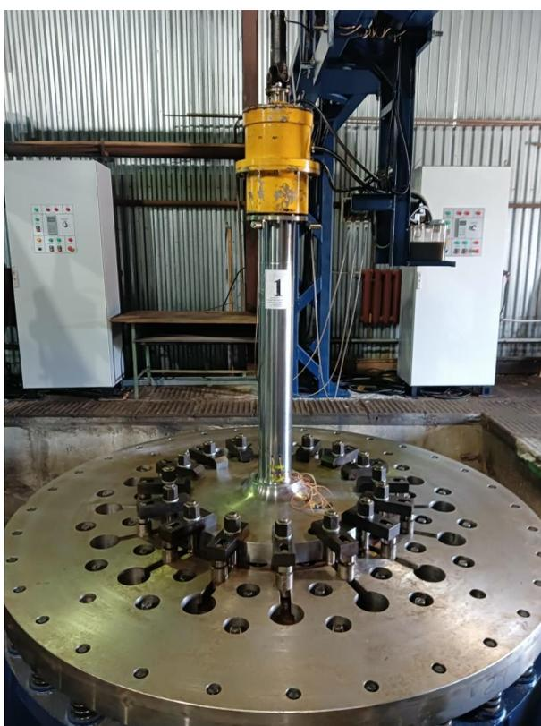
Рис. 3. Внешний вид объекта испытаний (ось в сборе с технологическим имитатором колеса)
